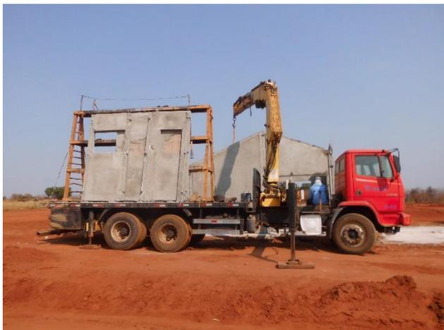
**Figura 4 – Transporte dos painéis**
